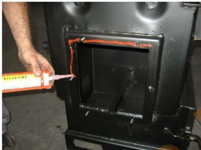
Рисунок 7. Нанесение жаростойкого силикона перед установкой прокладки.
